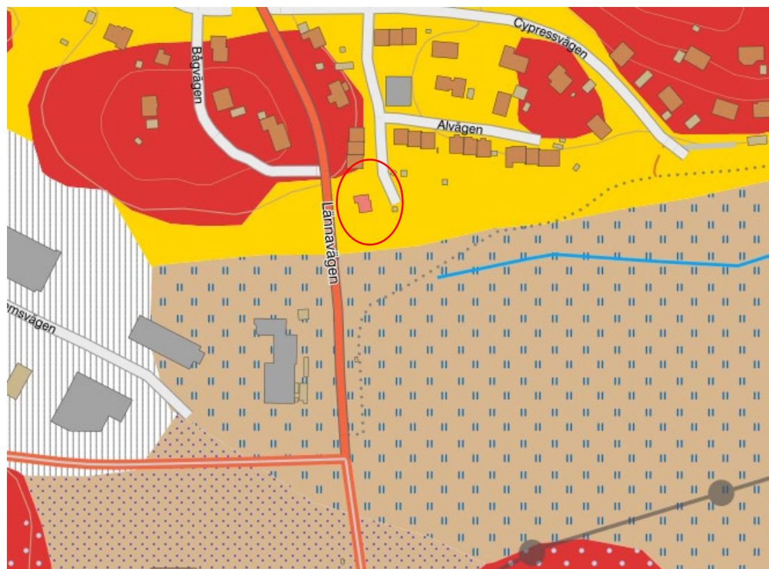
Figur 14. Jordartskartan, SGU 2025. Gult - glacial lera. Brunt med blå streck - Gyttja. Rött - urberg. Snedstreckat – fyllning. Planområdets ungefärliga läge inringat i rött
